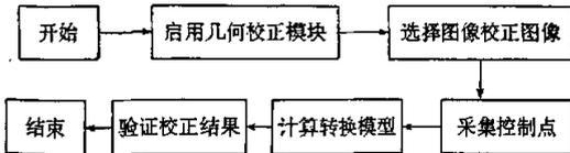
图1 卫星影像校正工作程序图
