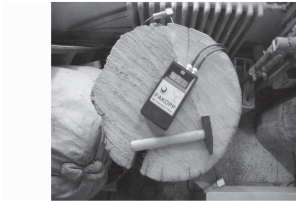
图 1 应力波速度检测试验
