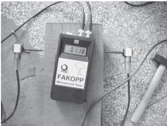
图 1 应力波速度检测试验
