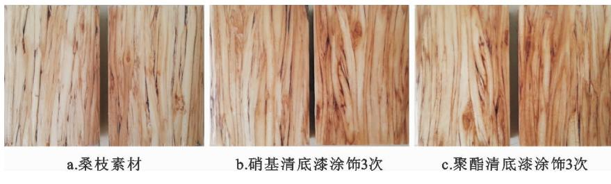
图 2 桑枝重组方材涂饰前后表面颜色变化
