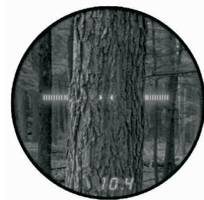
图5 缝隙刻度尺模式
