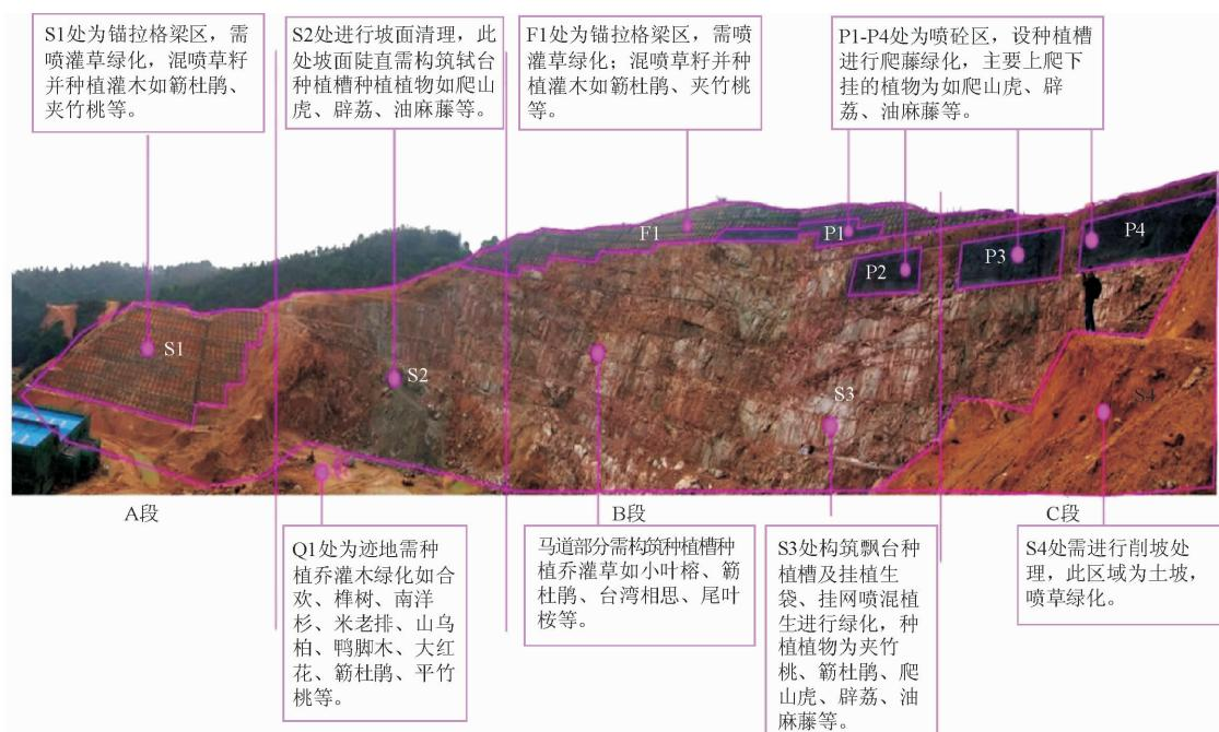
图1 根据坡面类型及立地条件分区分段制定有针对性的工艺方案
