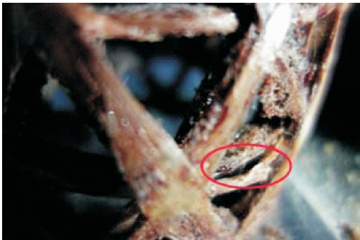
图 8 (PG) n 夹芯点阵圆筒的破坏形式:分层
