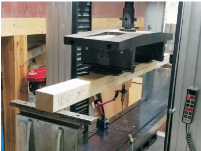
图 2 组合木梁四点弯曲加载测试
