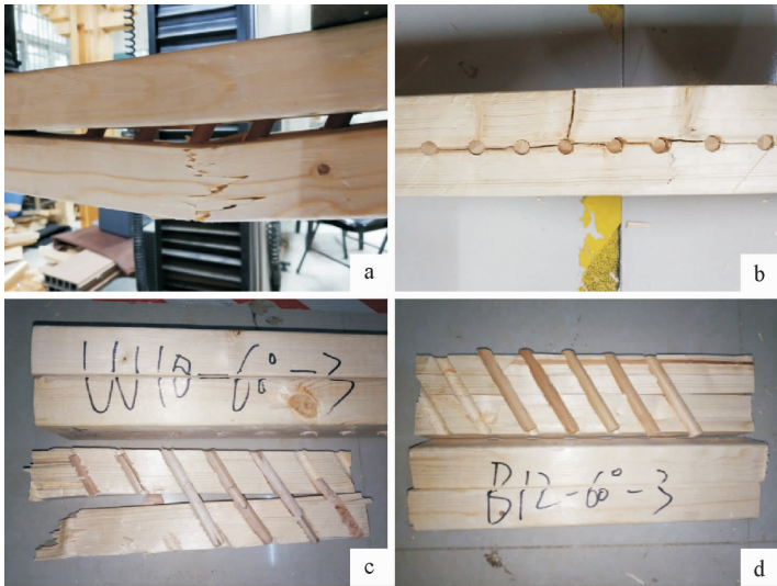
注:a. 组合木梁弯曲破坏;b. 组合木梁底部裂纹;c. 木销连接截面;d. 竹销连接截面。
