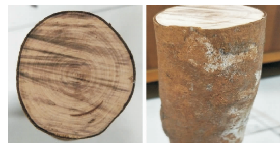
图 1 普通油茶木材试样宏观照片
