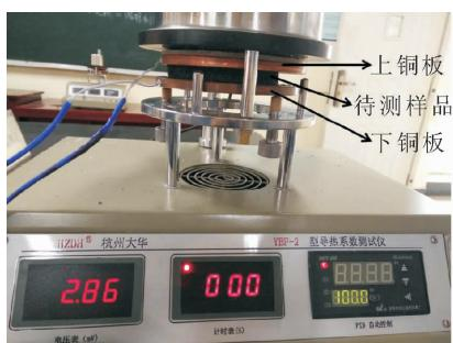
图 1 热传导系数测试仪
