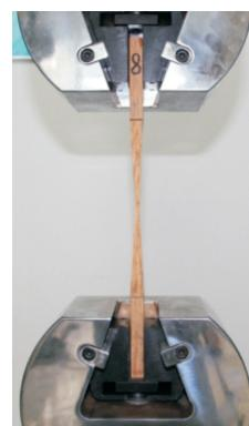
图 5 顺纹抗拉强度检测
