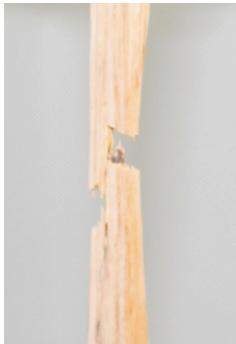
图9 纤维拉断和界面剪切同时发生
