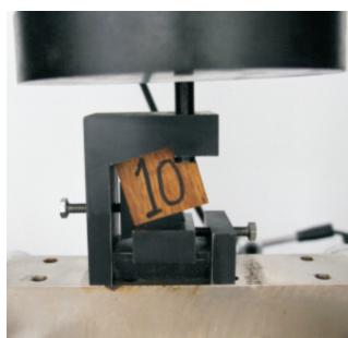
图 2 顺纹抗剪强度检测
