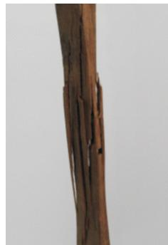
图8 锯齿状界面剪切破坏
