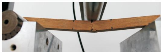
图11 纤维先拉断后压溃破坏
