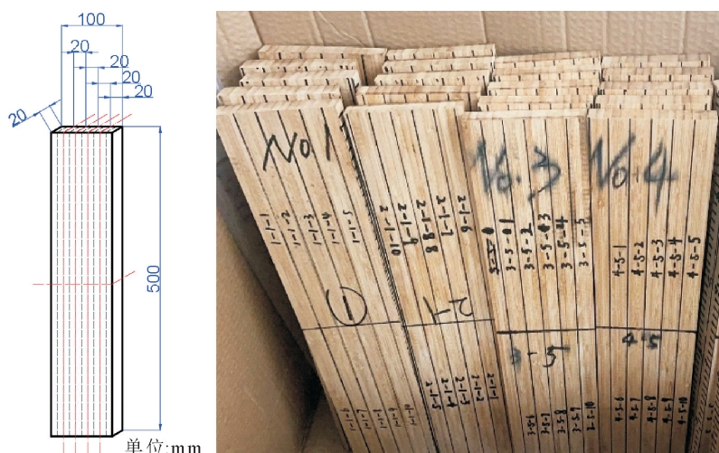
图 5 侧压竹集成材小试样切割加工示意
